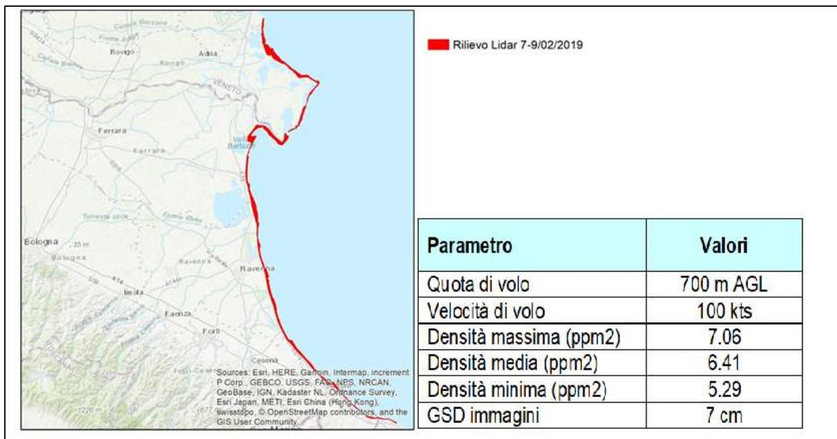
Il rilievo Lidar 2019, che è caratterizzato da una densità di punti molto elevata > 6 punti/m<sup>2</sup>, copre la fascia costiera più dinamica, ma non l'intero territorio potenzialmente interessato da inondazioni marina, ad eccezione del tratto costiero delle Marche. Per poter utilizzare la metodologia di analisi, il rilievo Lidar 2019
